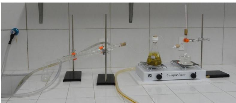
Figura 1. Aparato de destilação por arrasto de vapor.
