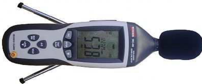
FIGURA 1. Decibélímetro - DEC-420 utilizados na medição de NPS
