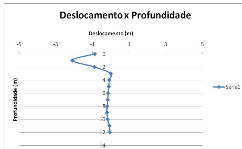
Figura 7 – Gráfico Deslocamento x Profundidade da estaca.
