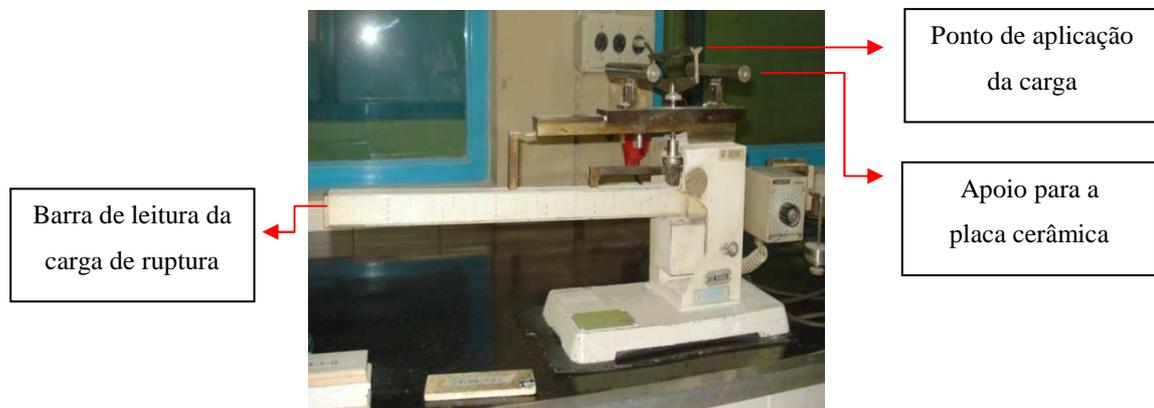
Figura 3 – Equipamento utilizado no ensaio do módulo de resistência à flexão.
