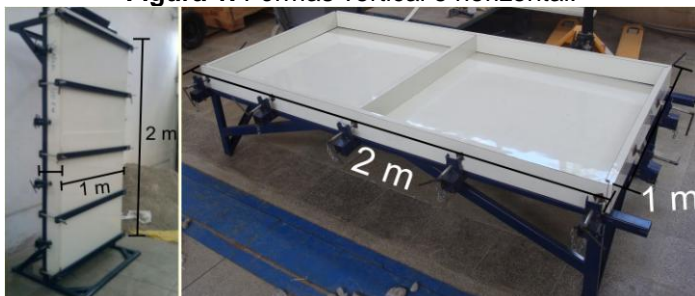
Figura 1. Fôrmas vertical e horizontal.
