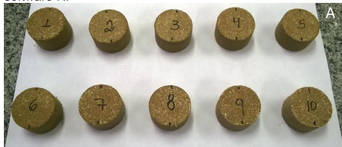
Figura 1: Briquetes formados a partir da composição 75% Licuri mais 25% Palha de Cana de Açúcar. (A) Vista de topo.
