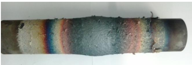
Figura 1: Depósito do aço supermartensítico média liga conformado por spray em forma de tubo.
