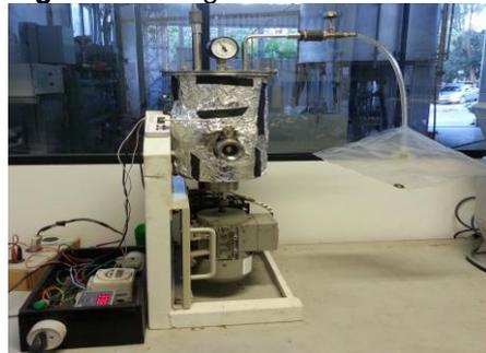
A batelada foi monitorada através do controle de pH (através do uso de fitas indicadoras), pressão (manômetro), temperatura (termômetro) e agitação.
