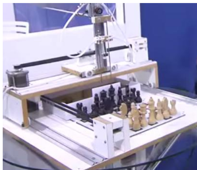
Figura 2. Base do tabuleiro e braços deslizantes.
