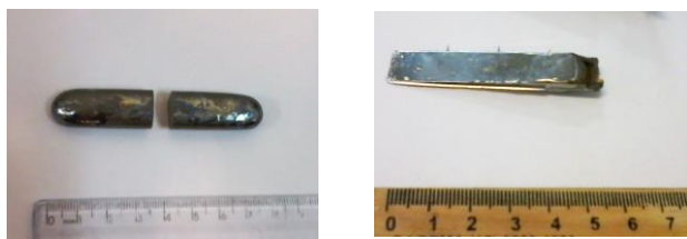
Figura 1 – Lingote produzido (esquerda) e cunha processada por sucção (direita).
