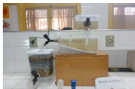
Protótipo da miniestação de tratamento de água construída pelos alunos.
