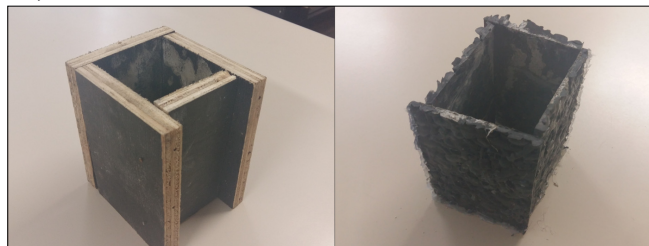
Figura 2: Forma de madeira (esquerda) e de PP (direita)
