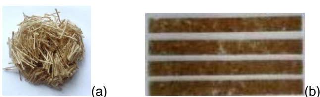
Figura 2. (a) fibras de juta – 5,0 mm e (b) corpos de prova.
