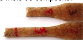
**Figura 3.** Compósito de poliéster e fibras de juta de 5,0 mm
