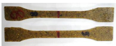
Figura 2- Corpos de prova antes do ensaio.
