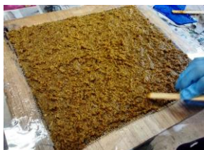
Figura 1- Lâmina de material compósito antes da cura.
