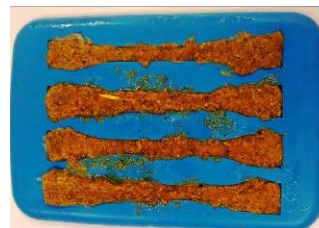
Figura 3- Molde silicone preenchido com o compósito.
