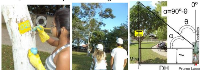
**Figura 1. a)** Numeração das árvores. **b)** Leitura da altura inicial na mira e ângulo vertical na copa da árvore. **c)** Representação do procedimento da coleta dos dados.
