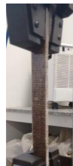
Figura 2. Corpo de prova na máquina de tração para a realização do ensaio na máquina Kratos.
