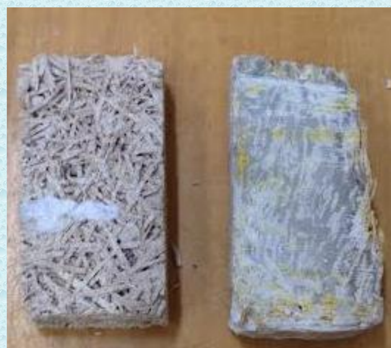
Figura 2:a) madeira de reflorestamento b) material sem cimento sorel c) material com cimento sorel
