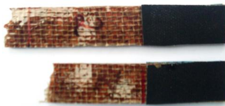
Figura 3. Corpo de prova fraturado
