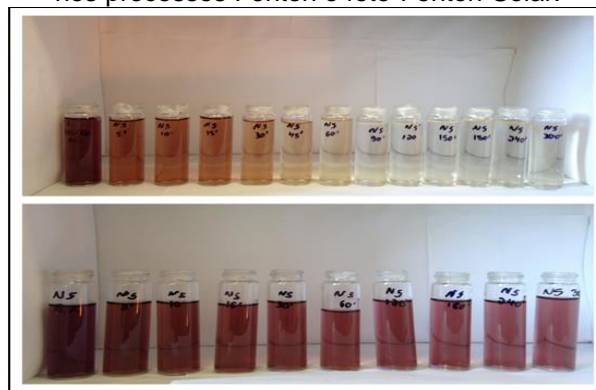
Figura 2 – Remoção de cor na amostra de efluente N5 nos dois processos.
