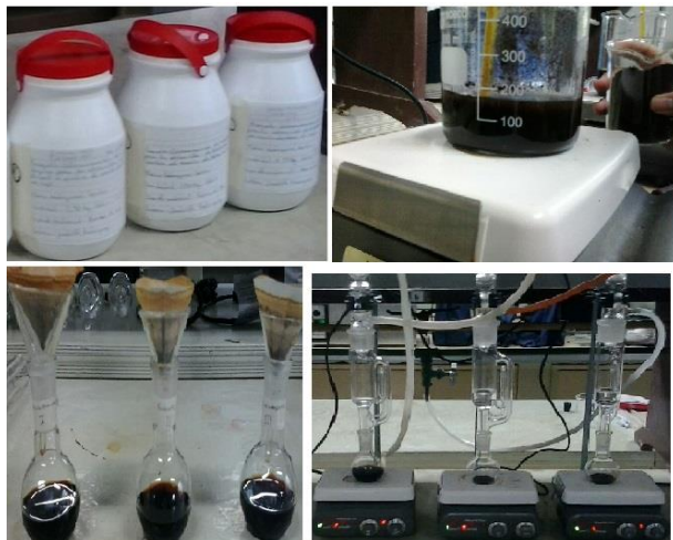
Figura 1. Processo de lixiviação da borra de café.
