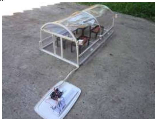
Figura 2. Maquete da estufa solar com o circuito eletrônico acoplado.
