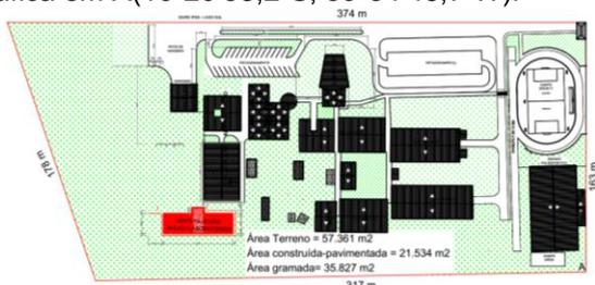
**Figura 1.** Desenho em AutoCAD da área estudada com as medidas obtidas por GPS com detalhes das áreas de construção-pavimentação e gramado-arborizada.
