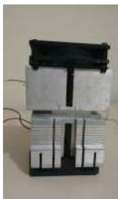
Figura 2. Montagem da pastilha, dissipador e cooler
