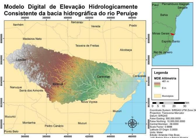
**Figura 3.** Modelo Digital de Elevação Hidrologicamente Consistente da bacia hidrográfica do rio Peruípe.
