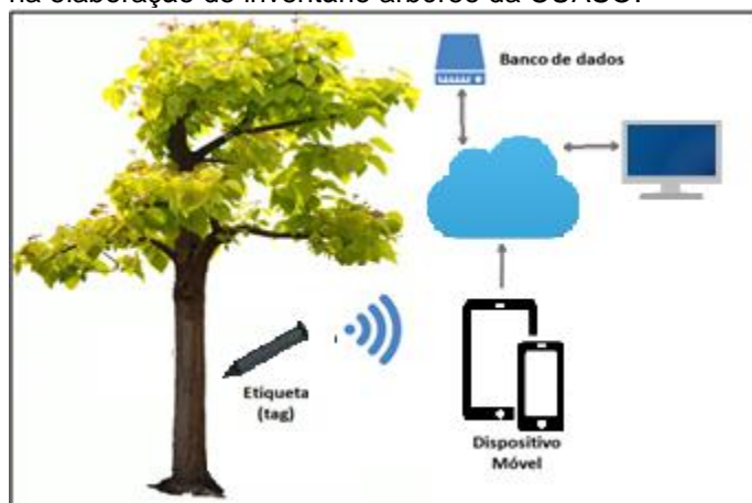
Figura 1. Imagem ilustrativa da tecnologia RFID utilizada na elaboração do inventário arbóreo da CUASO.
