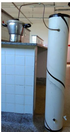
Com o aquecimento do recipiente houve o arraste de óleos essenciais que foram transportados juntamente com o vapor de água por meio de tubos de cobre que formam um espiral no interior do condensador - construído a base de cano PVC de 200mm.
