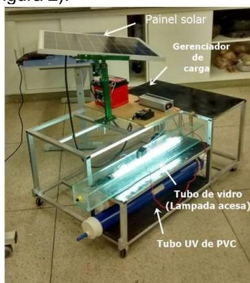
**Figura 2.** “Carrinho” para demonstrações públicas do “Tubo UV” alimentado por um sistema fotovoltaico de energia no IFMA Campus Imperatriz MA. Pode-se notar a placa solar, bateria, controlador de carga. Abaixo um modelo de “Tubo UV” de vidro onde nota-se a lâmpada UV de 20W acesa e na parte inferior um Tubo UV de PVC.
