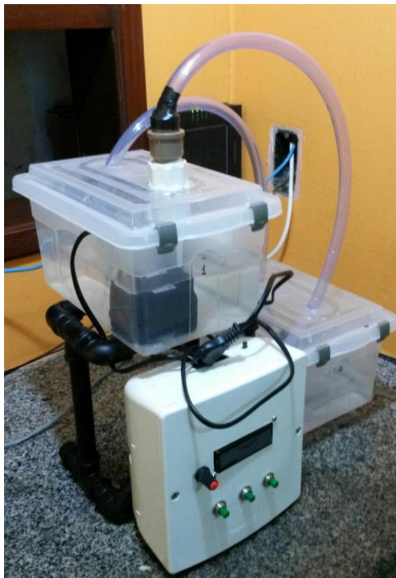
Figura 1. Protótipo do Sistema Inteligente de Controle para Fluidos Hídricos
