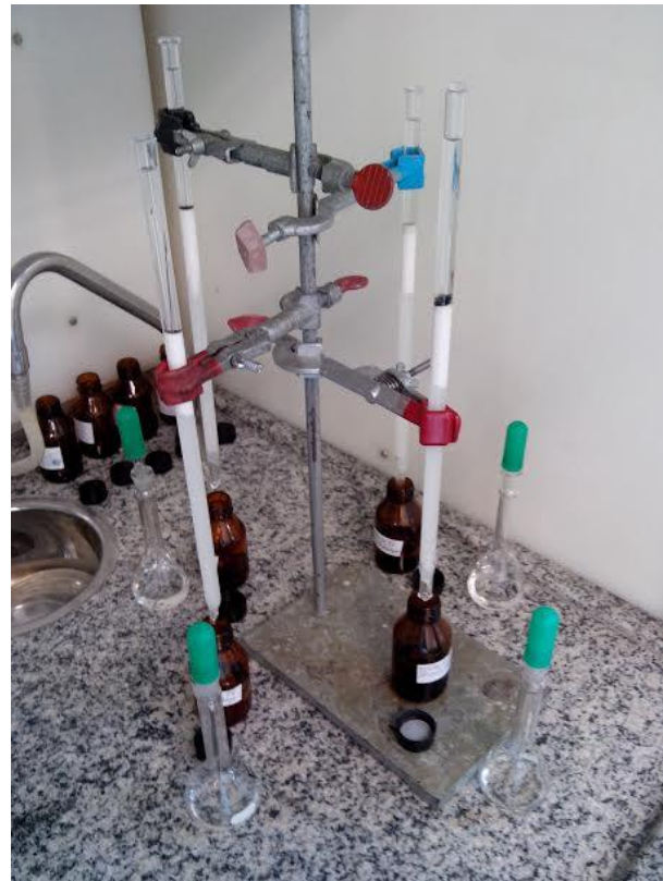
Figura 2 – Fracionamento em coluna cromatográfica de sílica e alumina.
