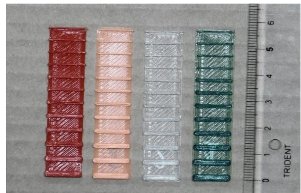
Figura 4. Corpos de prova do teste de precisão dimensional.
