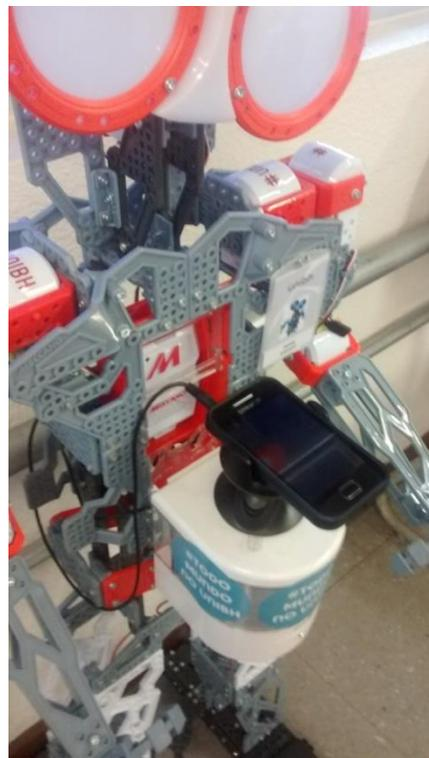
Figura 3: Ozires recebeu um dispensador automático de desinfetante de mão de álcool e um telefone celular. Todas as lições dadas pelo robô são produzidas no telefone celular usando um "aplicativo de mudança de voz" que produz vozes robóticas.
