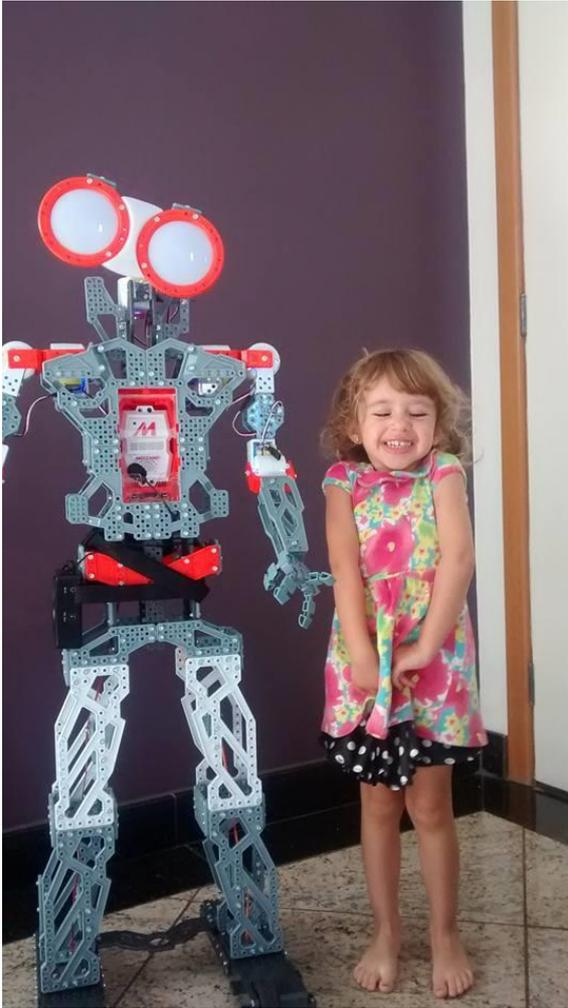
Figura 1: Mecanoide G15KS, um robô humanóide de 1,22 m de altura, é programável e responde a comandos de voz.
