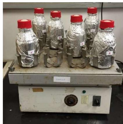
Esgotados os substratos fornecidos, era realizada a troca do meio com adição de nova alimentação. Para tal, o conteúdo dos frascos era centrifugado a 3600 rpm por 15 minutos, separando a biomassa do efluente a ser descartado. Os reatores eram realimentados com suas respectivas diluições de lixiviado e a biomassa centrifugada ressuspendida.
