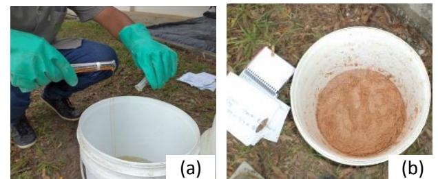
Figura 3 - Aditivo superplastificante e impermeabilizante. (a) Mistura na água para o traço do concreto. (b) Pó-de-serra colocados em 50% da água com o aditivo antes de ser colocado na betoneira. Fonte: Fangelo, 2016.
