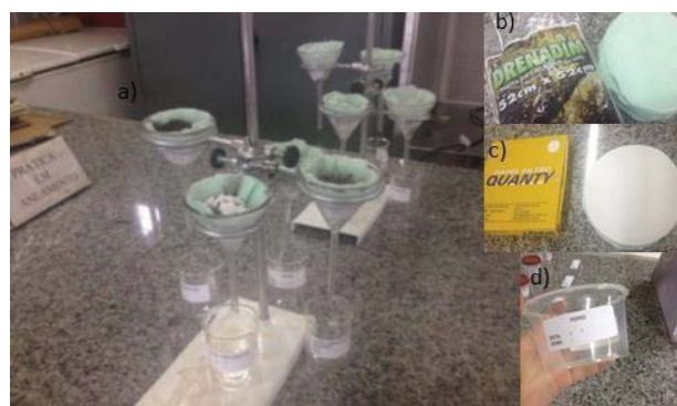
Figura 1 - Aparato experimental, a) coluna de lixiviação, b) manta geotêxtil, c) papel de filtro quantitativo d) recipiente para coleta
