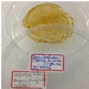
Figura 2. Material polimérico obtido a partir do acetato de celulose do bagaço da cana e LCC.
