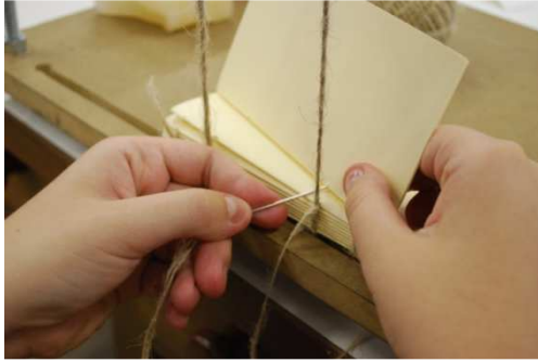
Imagem 3: Processo de costura alternada sobre nervos
