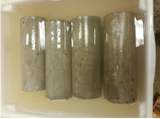
Figura 1: Corpo de prova cilíndrico imerso em solução de sulfato.
