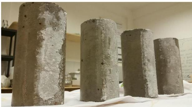
Figura 2: Corpo de prova (família 1, 2, 3 e 4) após ataque por sulfato.
