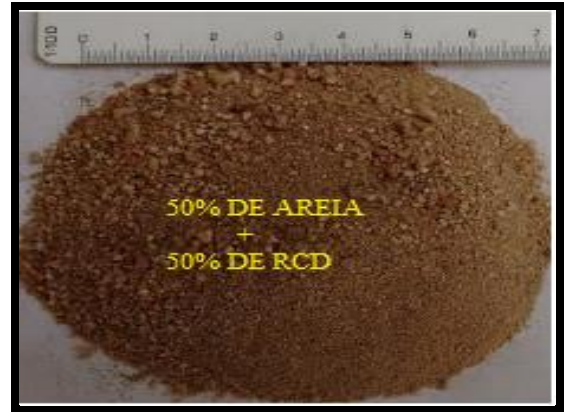
Figura 03 – Aspecto visual da composição binária com 50% de substituição – escala natural.
