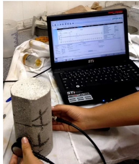
Figura 2 - Medição da propagação da onda ultrassônica em corpos de prova sem carregamento
