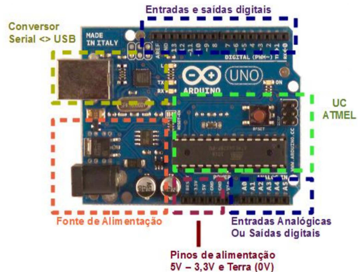
Figura 2: Estrutura Interna da plataforma Arduino UNO
