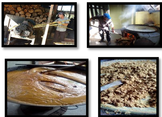
Fig. 1. Etapas do processo de produção de açúcar artesanal. Etapa 1. Produção do caldo de cana (moenda). Etapa 2. Evaporação da água (cozimento no tacho). Etapa 3. Início da cristalização do açúcar mascavo, com atingimento do ponto do melaço. Etapa 4. Após a secagem do líquido, o resultado é o açúcar mascavo. Fonte: Banco de dados do grupo de investigação.
