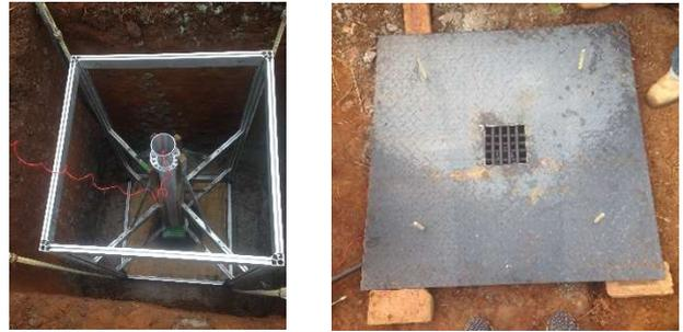
Figura 2 – (a) Plataforma posicionada no interior da vala. (b) Chapa de aço com abertura para exaustão de gases.
