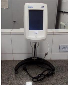
**Figura 2:** Viscosímetro utilizado para análises de viscosidade dos azeites de oliva extra virgem.**Tabela 1:** Condições de avaliação para as diferentes análises de viscosidade de azeite de oliva extra virgem.
