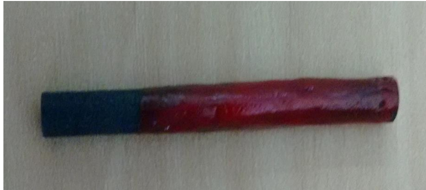
Figura 01: eletrodo de trabalho confeccionado a partir de pilhas descartadas.
