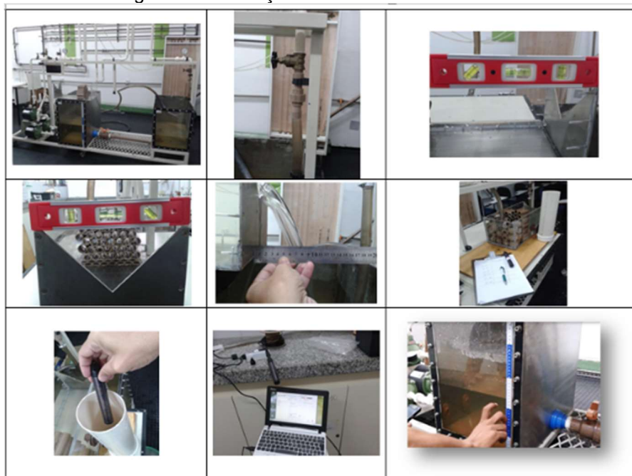
Figura 2 - Calibração do vertedor em laboratório.
