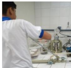
(c) Pressionamento do comprimido.
