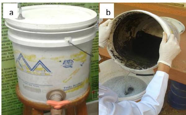
**Figura 1** - (a) Sistema 1 feito da adaptação de PVC de 20 litros; (b) Esgotamento do sistema
